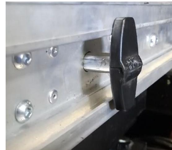
Dettaglio blocchetto per giunzione pedane integrato lateralmente, da ruotare per fissaggio tramite brugola
